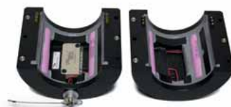
Корпус Dx в виде полукольца со встроенным источником питания (батарея или катушка вторичной обмотки для индуктивного питания)
