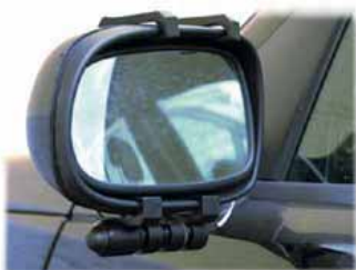
Зеркальная антенна Dх для бесконтактного размещения во время дорожных испытаний
