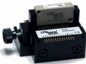
Испытательная панель Dх для быстрой конфигурации и испытаний без необходимости спаивания
