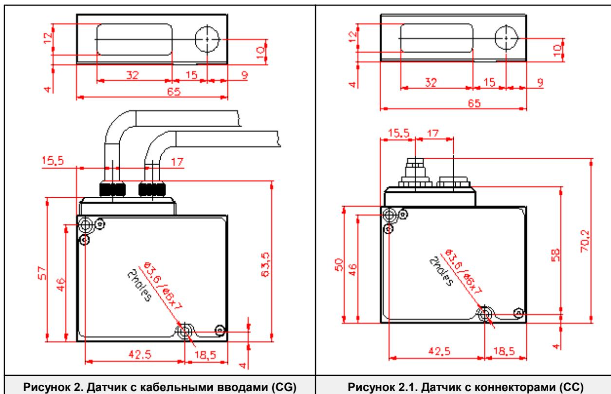
Рисунок 2. Датчик с кабельными вводами (CG)
