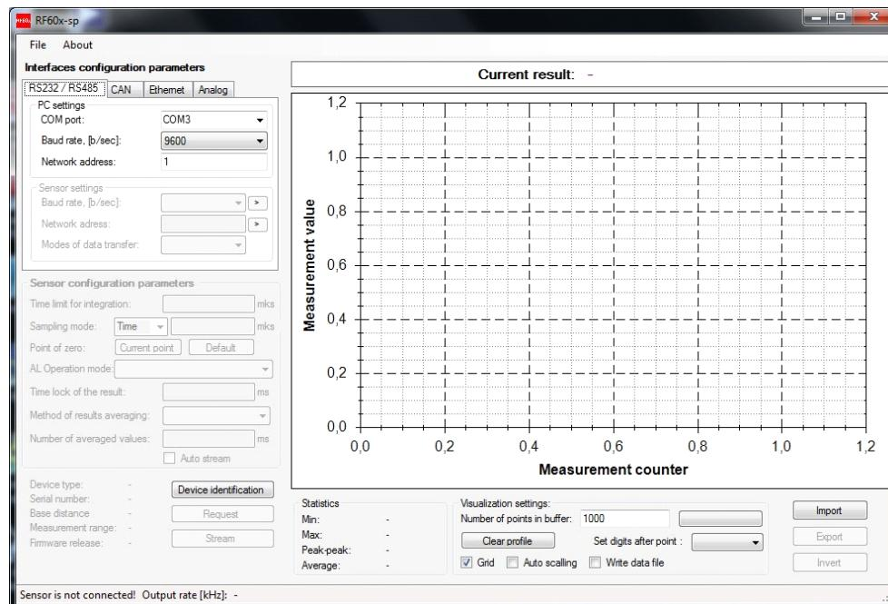
Для установки соединения по RS232/RS485 интерфейсам необходимо во вкладке **RS232/RS485 PC settings** панели **Interface configuration parameters**:
