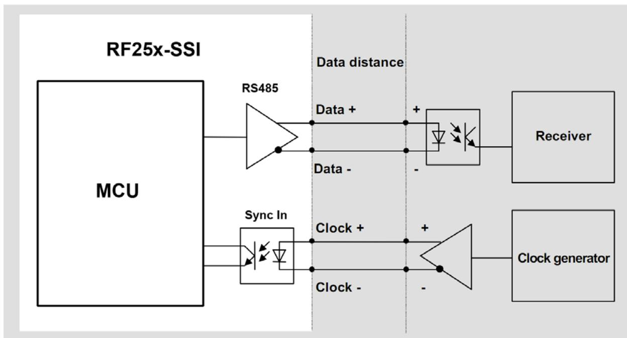
В данном режиме вход синхронизации датчика используется в качестве входа сигнала Clock, а линии интерфейса RS485 – для передачи сигнала Data. Уровень сигналов Clock и Data – 5В.
