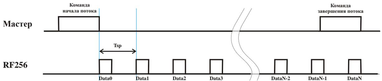
$T_{sp} = \text{Sampling Period} * 0.01\text{mS}$  - период выборки      Data0, Data1 ... DataN - синхронизированные пакеты данных
