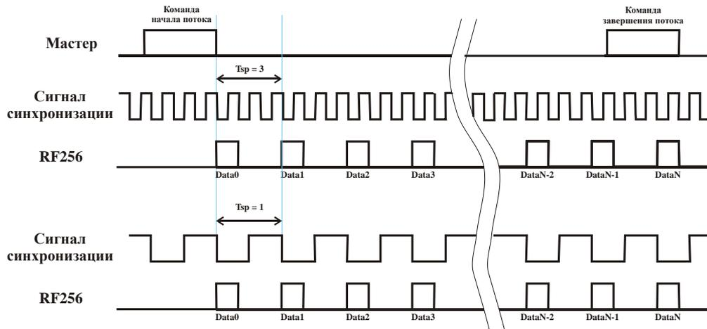
$T_{sp} = \text{Sampling Period}$  - период выборки      Data0, Data1 ... DataN - синхронизированные пакеты данных
