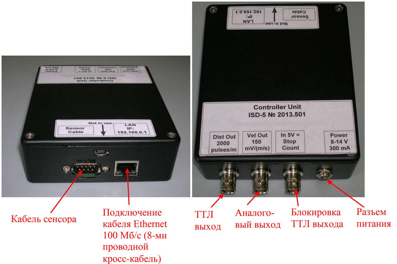
Рисунок 1. Состав измерителя и назначение разъемов.
