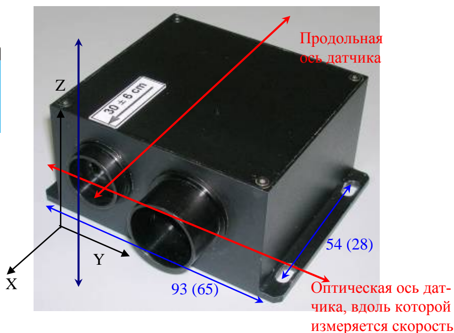
Рис. 2. Ориентация датчика относительно движущегося объекта по оси Y (продольный вариант). Также возможен поперечный вариант (оптическая ось датчика – по оси Z (синяя стрелка)).
