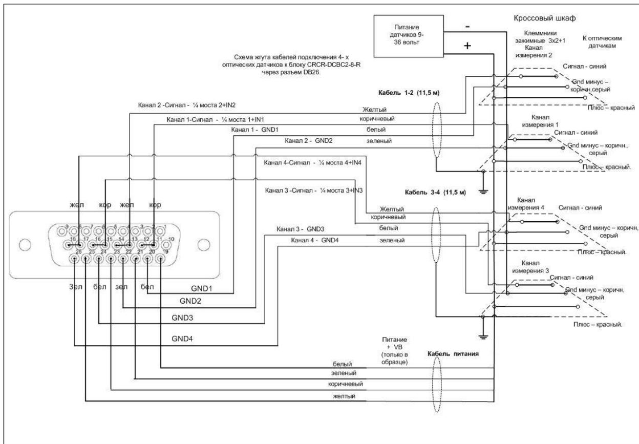
Схема подключения 4-х тензодатчиков к блоку CRCR-DCBC2-8-R через разъем DB26.
