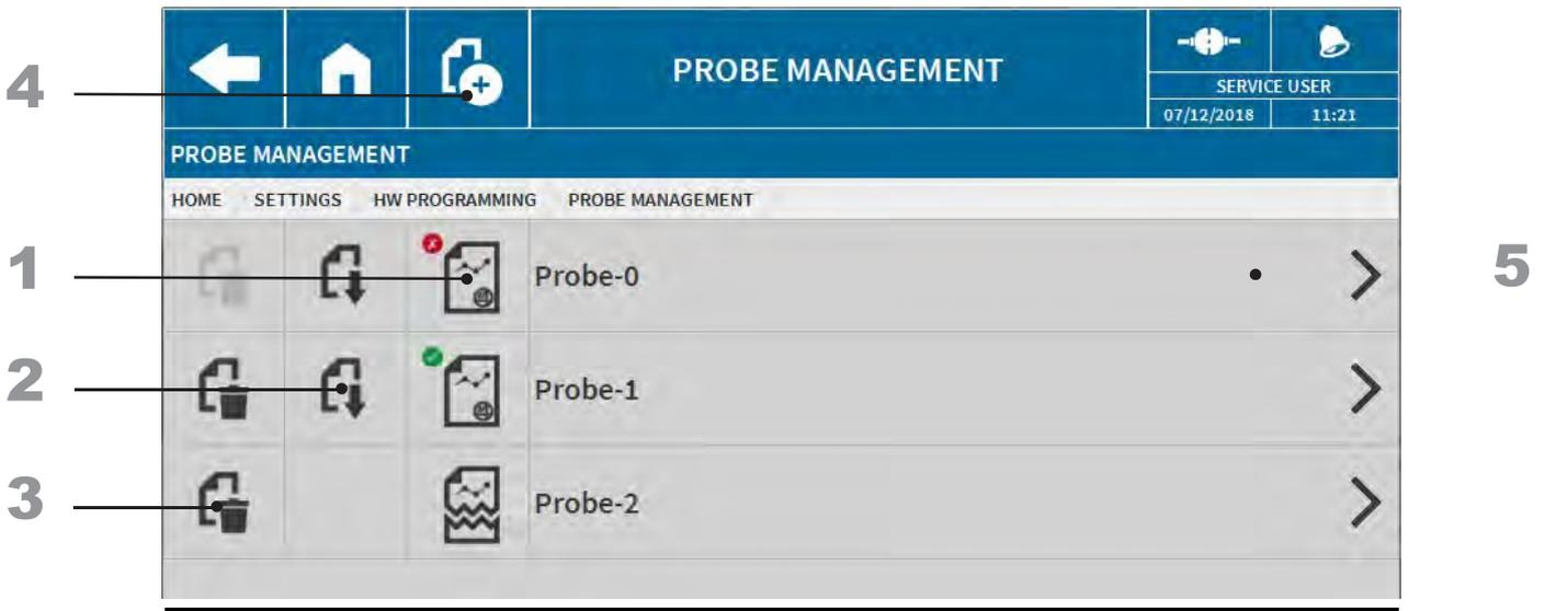
Рис.50. Экран списка подключаемых датчиков
