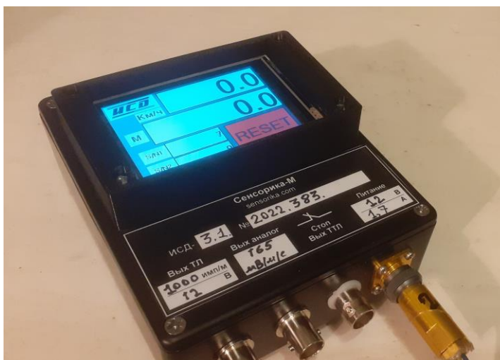
Рисунок 3 – Вариант модуля обработки сигналов с комбинированным индикатором длины и скорости.
