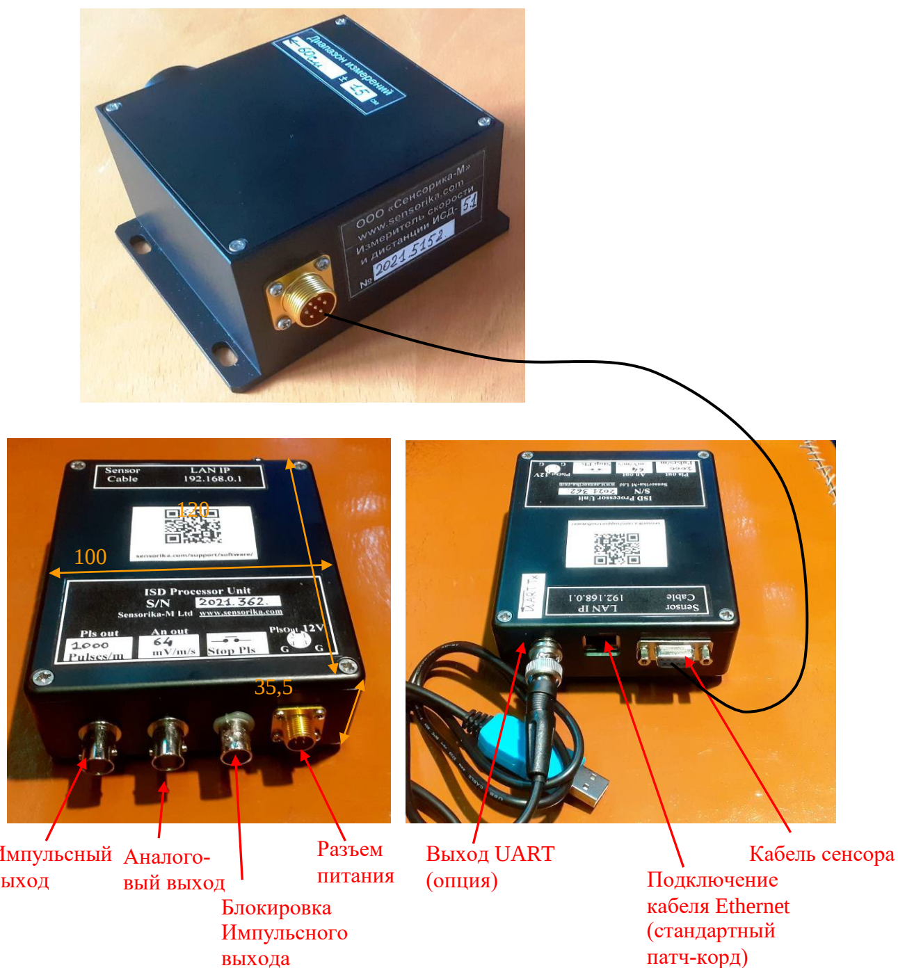
Рисунок 1. Состав измерителя и назначение разъемов.
