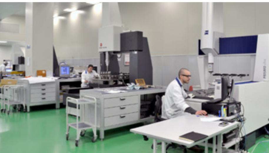
Все полы помещений изолированы от здания и/или закреплены на анти-вибрационных подшипниках.; Комнаты находятся под небольшим избыточным давлением для выветривания пыли с поддержанием температуры  $20^{\circ}\text{C} \pm 0.3^{\circ}\text{C}$  (или даже  $\pm 0.2^{\circ}\text{C}$  для некоторых лабораторий) и относительной влажности  $50\% \pm 10\%$ .
